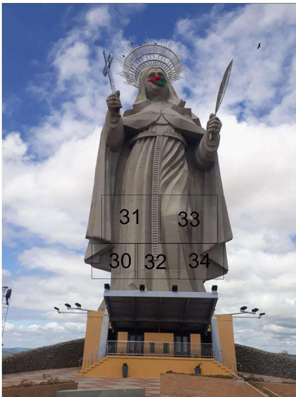
Figura 17 Área de alcance do terceiro anel de iluminação
